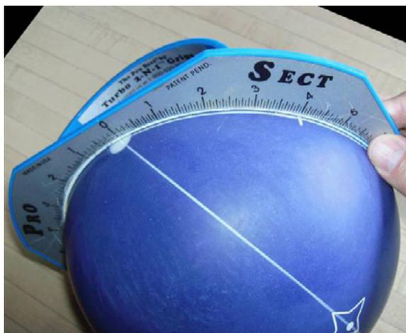
**5.** Mide y marca el ángulo entre la línea Pin-PAP y la VAL (Línea vertical del eje) poniendo el punto cero sobre el PAP y la costilla en la línea Pin-PAP. Ahora mide y marca el ángulo a la VAL utilizando el transportador.
