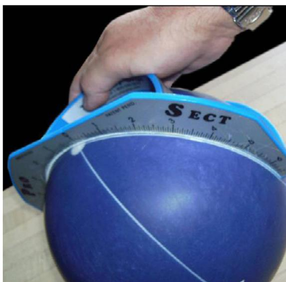
**4.** Mide y marca la distancia Pin-PAP sobre la línea del paso anterior utilizando la escala de pulgadas de la Pro Sect® esta marca será el PAP (Punto positivo del eje o Positive Axis Point).
