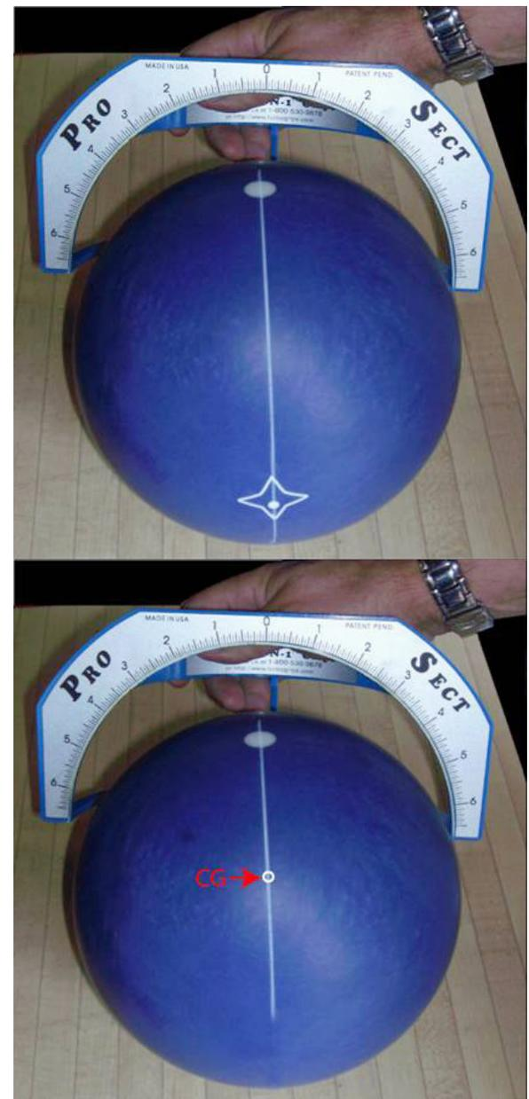
**2.** Mide y marca el ángulo de perforación, poniendo el punto cero de la Pro Sect sobre el Pin con la costilla sobre la línea de base, utilizando el transportador para medir y marcar el ángulo de perforación deseado.
